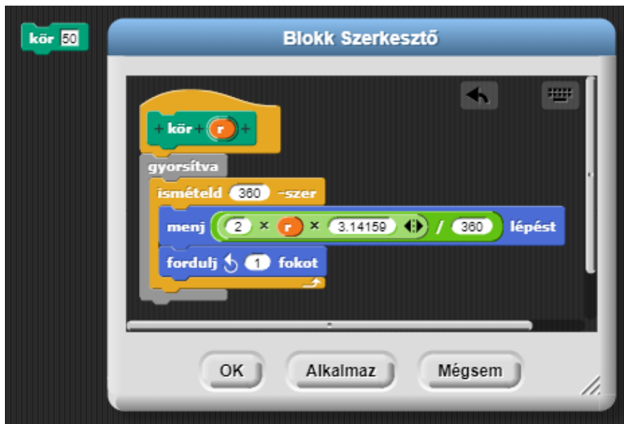
13. ábra A „gyorsítva” blokkba helyezett programrész futása közben a Snap! nem rajzolja ki a szereplőt, ezáltal lényegesen rövidül a programrész végrehajtási ideje
