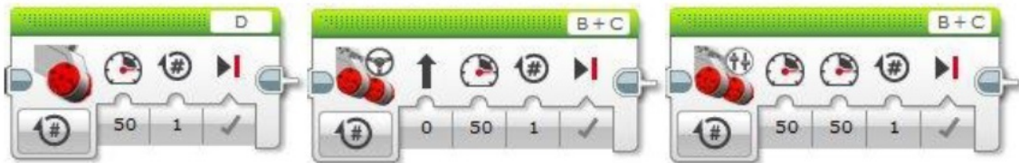
7. ábra. Motorblokkok (balról jobbra Large Motor, Move Steering, Move Tank)
